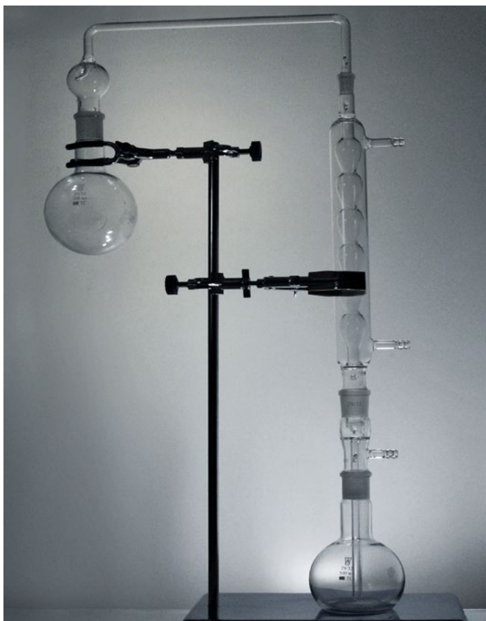
Прибор для определения фенола в воде
