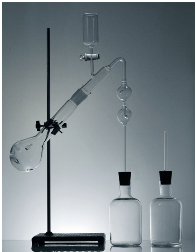
Аппарат для определения мышьяка
