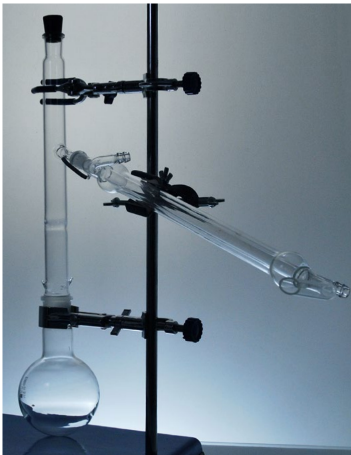
Прибор для количественного определения спирта в настойках
